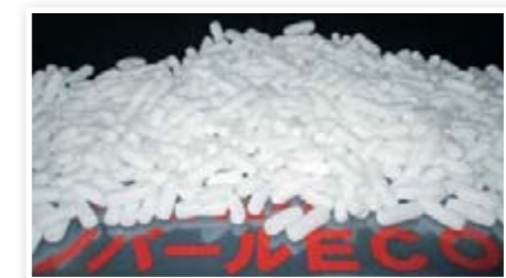
ロハセル ポリメタクリルイミド(PMI) の硬質発泡材です。
